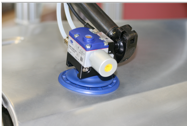
Децентрализованное создание вакуума эжектором SEAC RP с системой сброса прямо на присоске
